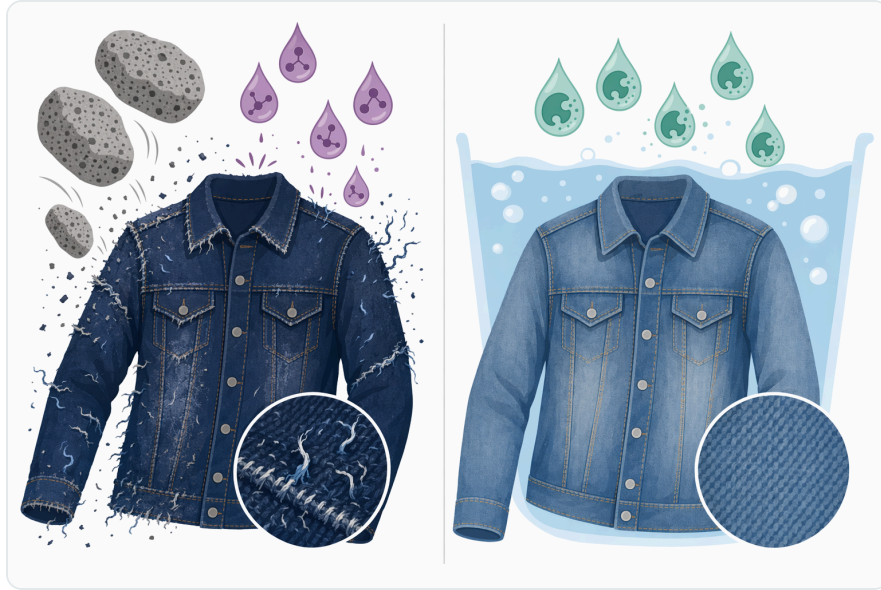
Figure 3. 셀룰라아제 기반 탈색은 염료를 포함한 면 표면 물질을 제거하는 방식인 반면, 라카아제 계열의 탈색은 반응하기 쉬운 염료 발색단의 산화적 변화를 통해 작용한다.
