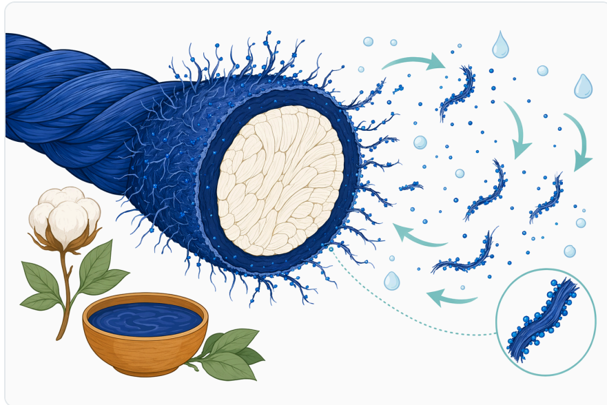
Figure 1. 효소 데님 워싱에서 인디고가 탈색되는 현상은 주로 표면 효과인데, 눈에 보이는 파란색의 상당 부분이 실의 바깥쪽에 집중되어 있기 때문이다
