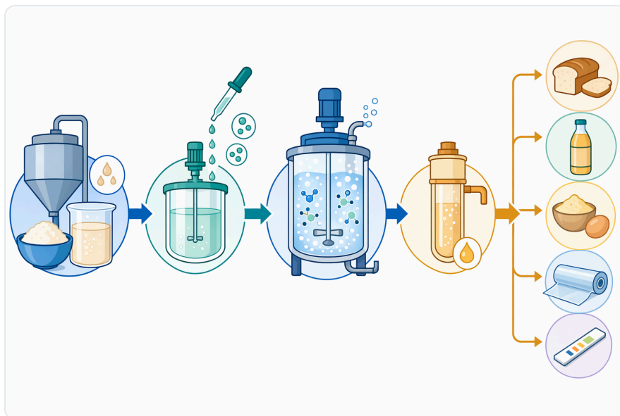
Figure 2. 산업용 글루코스 산화효소 공정은 제어된 투입과 통기를 결합하여 식품 및 진단 분야에서 산소 제거 또는 산화 효과를 생성한다.
