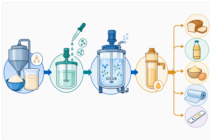
Figure 2. 산업용 포도당 산화효소 공정은 식품 및 진단 분야에서 산소 제거 또는 산화 효과를 얻기 위해 제어된 투입과 통기를 결합한다.
