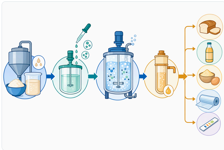
Figure 2. 산업용 글루코스 산화효소 공정은 제어된 투입과 통기를 결합하여 식품 및 진단 분야에서 산소 제거 또는 산화 효과를 만들어낸다.
