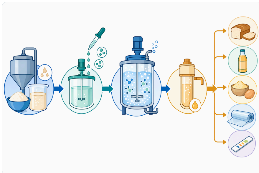
Figure 2. 산업용 글루코스 산화효소 공정은 식품 및 진단 분야에서 산소 제거 또는 산화 효과를 내기 위해 제어된 투입과 통기를 결합한다.
