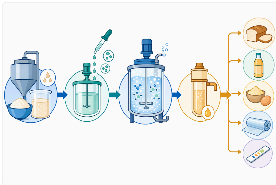
Figure 2. 산업용 글루코스 산화효소 공정은 제어된 투입과 통기를 결합해 식품 및 진단 분야에서 산소 제거 또는 산화 효과를 만들어냅니다.
