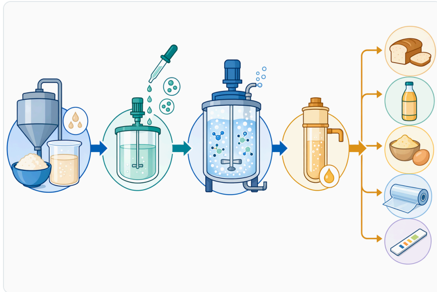
Figure 2. 산업적 글루코스 산화효소 공정은 제어된 투입과 폭기를 결합하여 식품 및 진단 분야에서 산소 제거 또는 산화 효과를 만들어냅니다.
