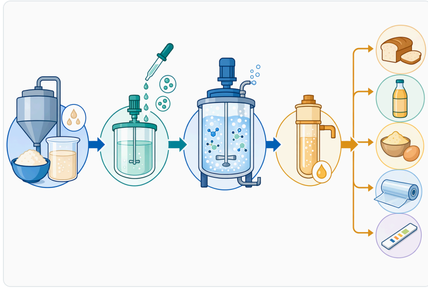
Figure 2. 산업용 글루코스 산화효소 공정은 식품 및 진단 분야에서 산소 제거 또는 산화 효과를 얻기 위해 제어된 투입과 통기를 결합합니다
