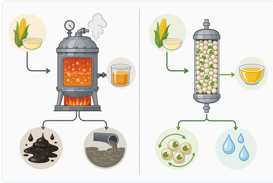
Figure 4. 비효소적 당 이성화와 비교할 때, 글루코스 이성화효소는 더 온화한 조건에서 분해 부산물이 적고 선택적으로 과당을 생산할 수 있게 한다
