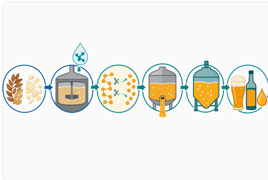
Figure 2. 在釀造與蒸餾中，液態葡萄糖澱粉酶會添加至醪液或麥汁中，促使澱粉轉化為高度可發酵的糖類。
