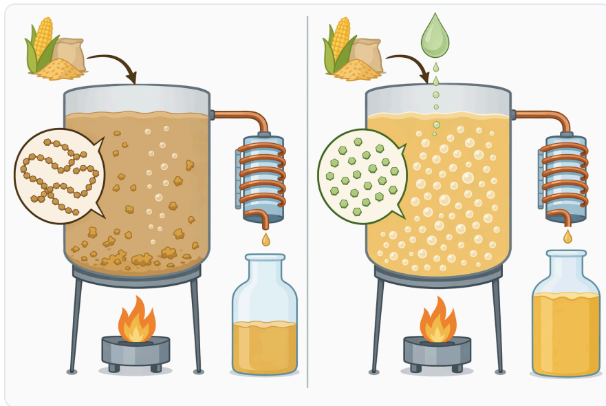
Figure 4. 맥아 효소에만 의존하는 경우와 비교해, 글루코아밀라아제를 추가하면 전분이 풍부한 매시에서 포도당 방출, 발효도, 최종 발효성 수율이 증가합니다.
