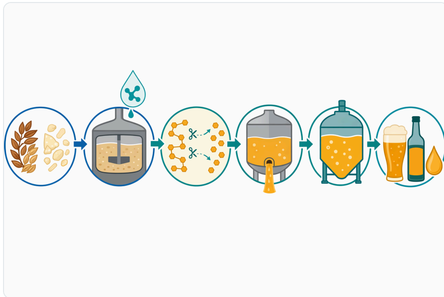
Figure 2. 양조 및 증류 공정에서는 액상 글루코아밀라아제를 매시나 맥즙에 첨가해 전분 전환을 발효성이 높은 당 쪽으로 촉진합니다.
