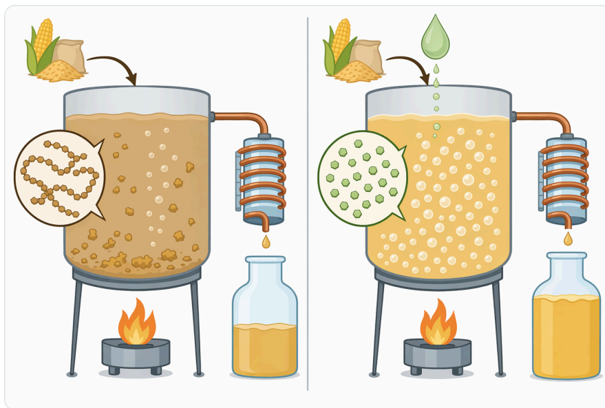
Figure 4. 맥아 효소에만 의존하는 경우와 비교해, 글루코아밀라아제를 추가하면 전분이 풍부한 매시에서 포도당 방출, 발효도 및 최종 발효 가능 수율이 증가합니다.
