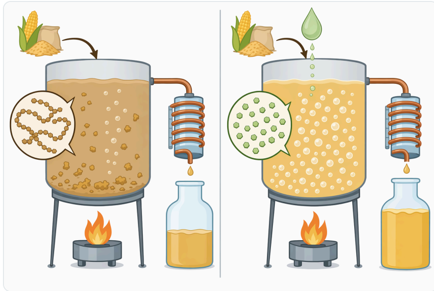
Figure 4. 맥아 효소에만 의존하는 경우와 비교해, 글루코아밀라아제를 추가하면 전분이 풍부한 매시에서 포도당 방출, 발효도 및 최종 발효성 수율이 증가합니다
