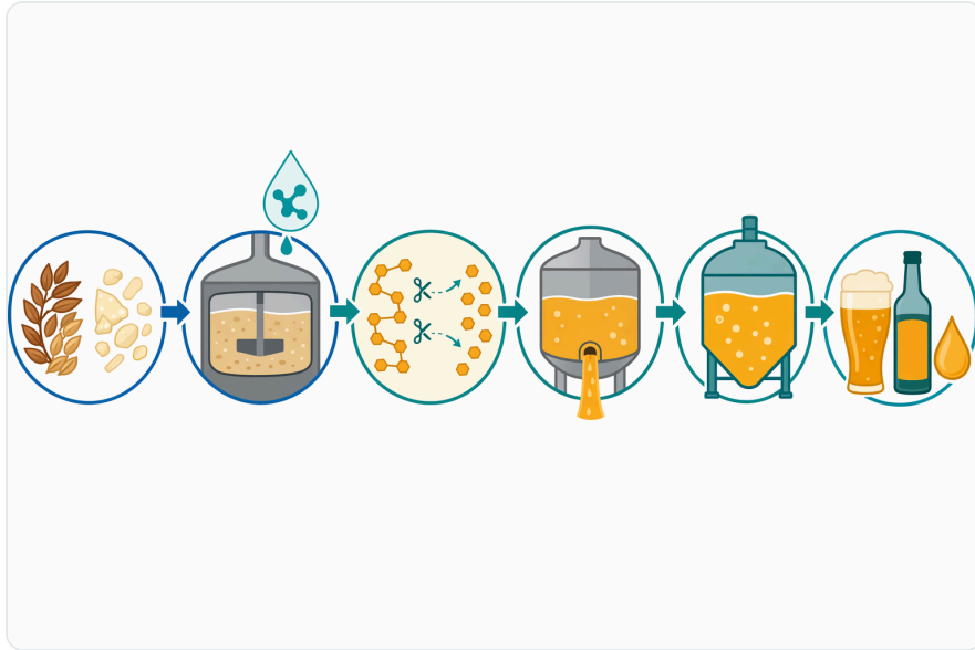
Figure 2. 양조 및 증류 공정에서는 액상 글루코아밀라아제를 매시나 맥즙에 투입하여 전분 전환을 발효성이 높은 당 쪽으로 유도합니다
