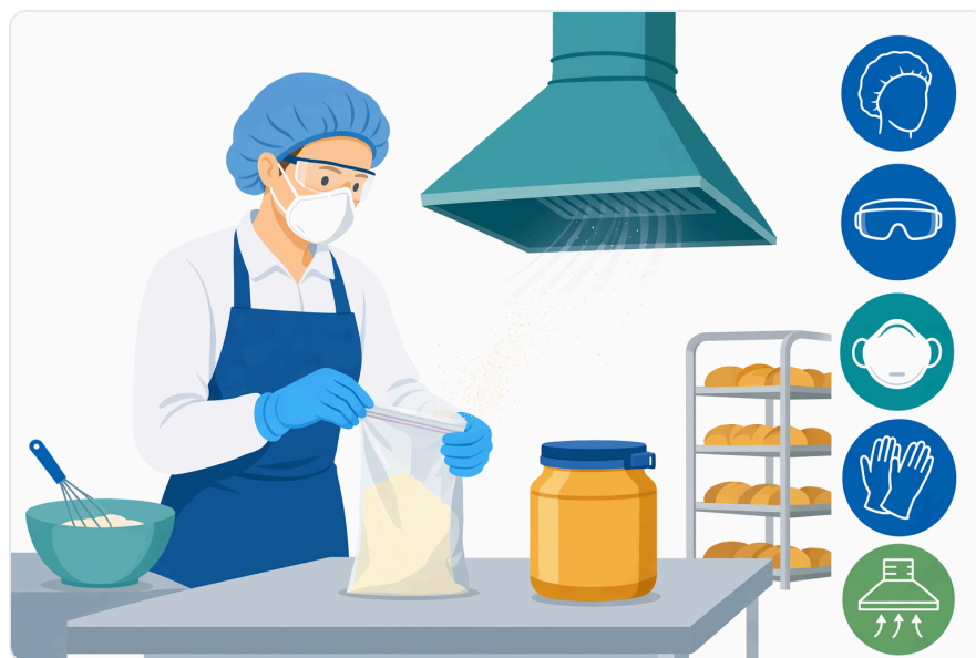
Figure 6. 粉狀酵素製劑需要採取減少粉塵的操作方式，因為酵素蛋白可能造成呼吸道致敏。
