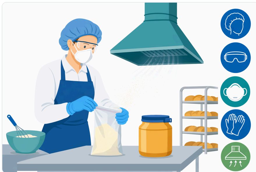
Figure 6. 분말 형태의 효소 제제는 효소 단백질이 호흡기 감각 물질이 될 수 있으므로 분진 발생을 최소화하도록 취급해야 한다.
