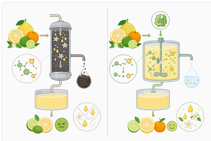
Figure 3. 람노시다아제는 결합 특이적으로 작용하는 반면, 나린지나아제 연쇄 반응과 비효소적 쓴맛 제거 방법은 서로 다른 메커니즘으로 감귤류 기질을 변화시킨다.
