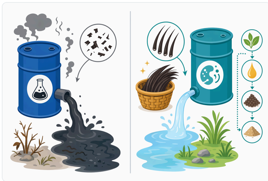
Figure 6. 효소 보조 털 보존 탈모는 황화물 사용량이 많은 공정에 비해 털의 분해를 줄이고 오염이 적은 빔하우스 운영을 지원할 수 있습니다.
