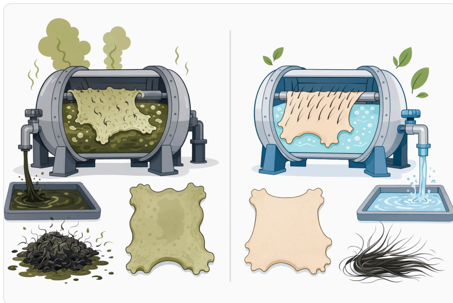
Figure 3. 석회-황화물 탈모는 주로 케라틴을 공격해 털을 분해할 수 있는 반면, 효소 보조 탈모는 털을 고정하는 주변 환경을 약화시키는 데 초점을 둡니다.
