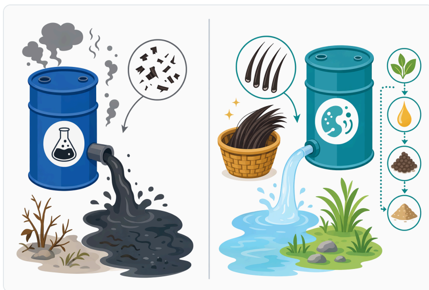
Figure 6. 효소 보조 털 보존 탈모는 황화물 사용이 많은 공정에 비해 털의 펄프화를 줄이고 오염이 적은 빔하우스 운영을 지원할 수 있다.
