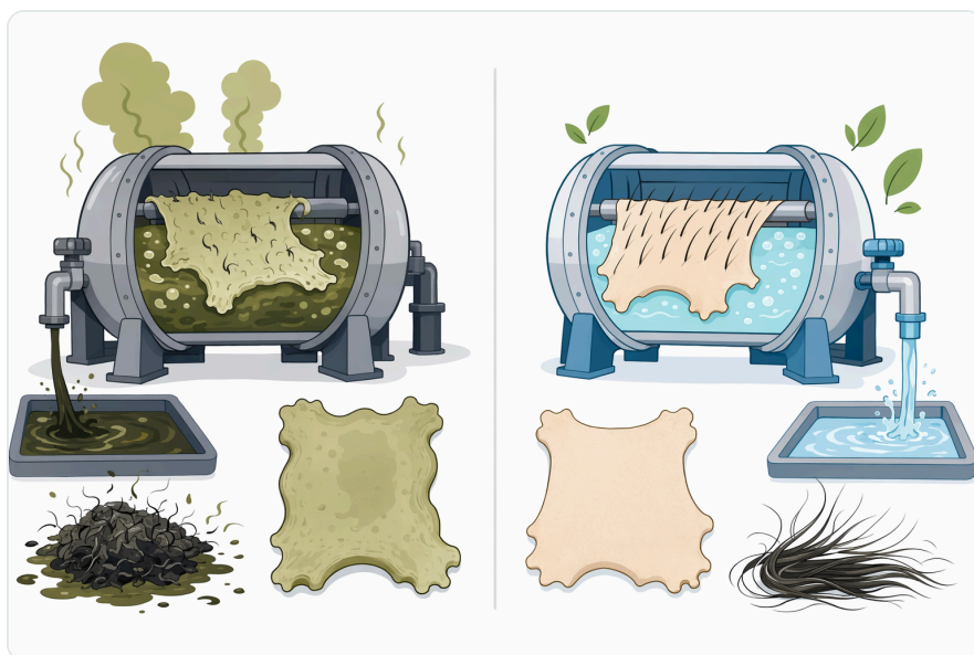
Figure 3. 석회-황화물 탈모는 주로 케라틴을 공격해 모발을 분해할 수 있는 반면, 효소 보조 탈모는 모발을 고정하는 주변 환경을 약화시키는 데 초점을 둔다.
