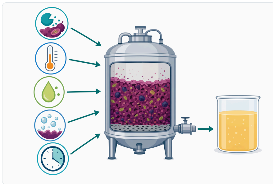
Figure 7. Hiệu quả của pectinase phụ thuộc vào mức độ tiếp xúc với pectin có thể tiếp cận được, thứ tự xử lý, nhiệt độ, độ axit, môi trường cồn và thời gian phản ứng.
