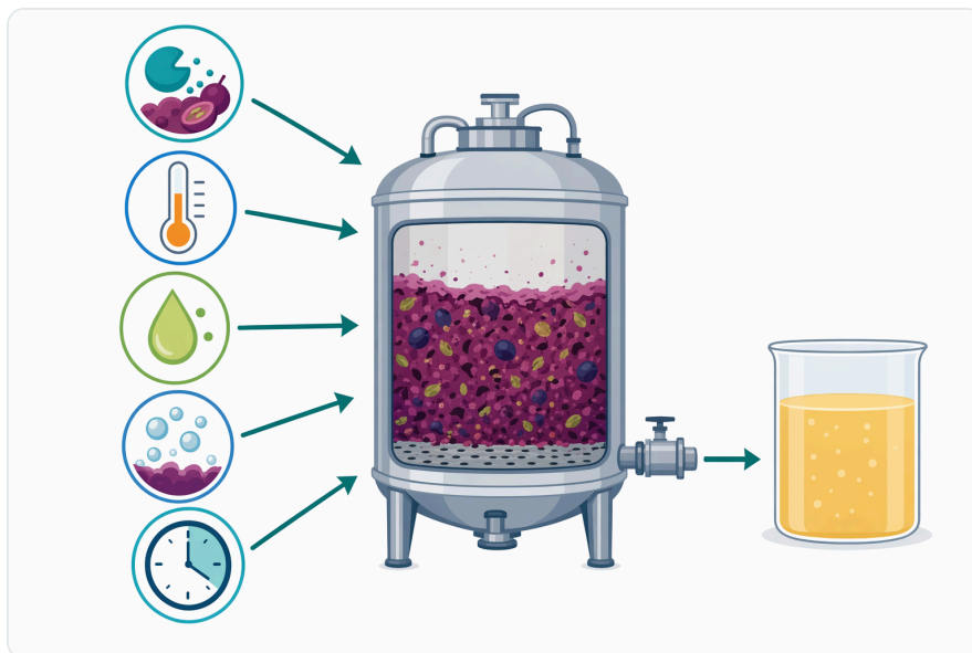
Figure 7. 펙티나아제의 성능은 접근 가능한 펙틴과의 접촉, 공정 순서, 온도, 산도, 알코올 환경, 반응 시간에 따라 달라집니다.
