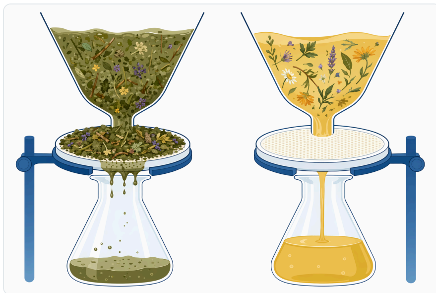
Figure 4. 透過縮短果膠鏈，果膠酶可改善富含果膠的植物性液體之澄清效果，並降低過濾阻力。
