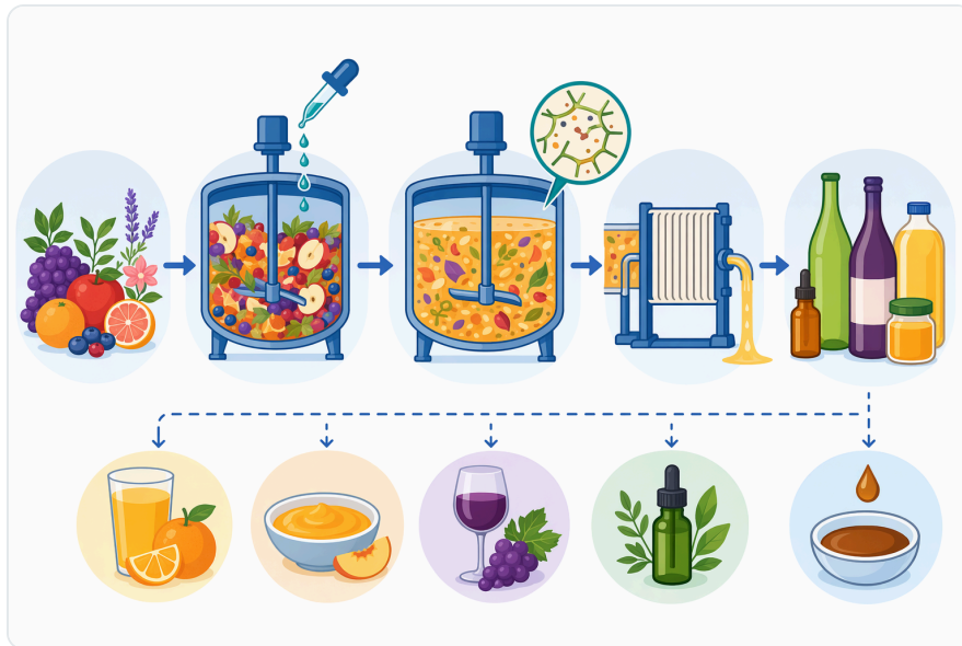
Figure 7. 果膠酶通常在潤濕或浸漬之後施用，並在壓榨、離心、過濾、精製、濃縮或乾燥之前進行。
