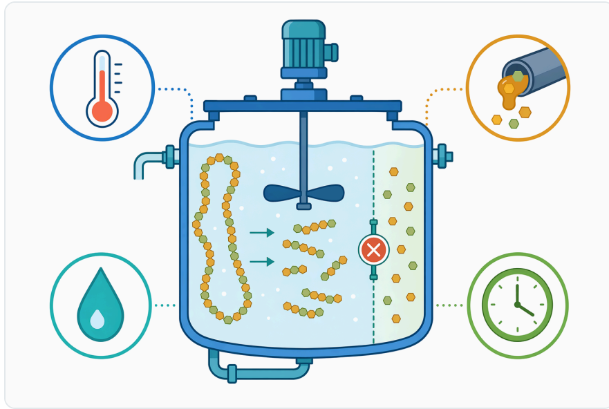
Figure 4. 온도, pH, 고형분 농도, 혼합, 반응 시간은 이눌리나아제 처리 과정에서 FOS가 축적될지 더 작은 당으로 계속 분해될지에 영향을 미친다
