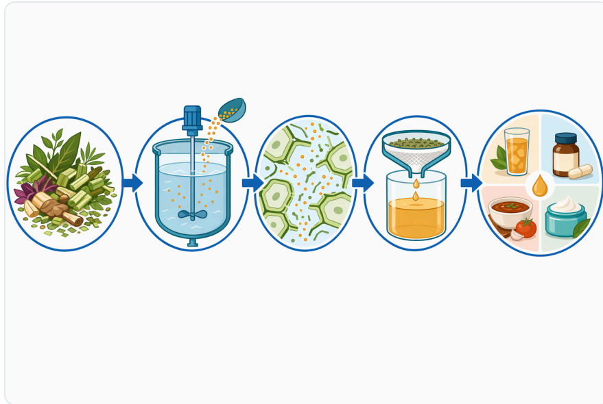
Figure 8. 典型的酵素輔助萃取流程，會在澄清與後續精製之前，於水相浸漬、浸泡、漿料保溫或萃取步驟中加入 \beta -葡聚醣酶。
