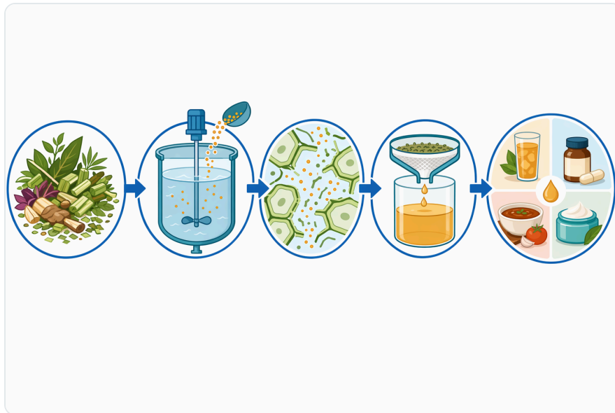
Figure 8. 일반적인 효소 보조 추출 공정에서는 청징 및 후속 마무리 공정 전에 수성 마쇄, 침지, 슬러리 유지 또는 추출 단계에서 \beta -글루카나아제를 첨가합니다.
