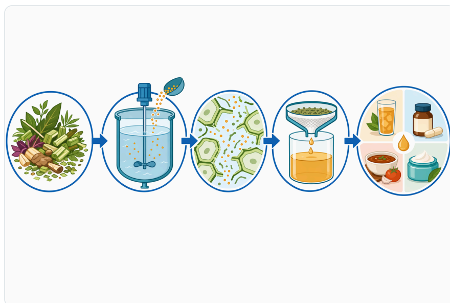
Figure 8. 일반적인 효소 보조 추출 공정에서는 정화 및 후속 마무리 공정 전에 수성 마쇄, 침지, 슬러리 유지 또는 추출 단계에서 \beta -글루카나아제를 첨가한다.
