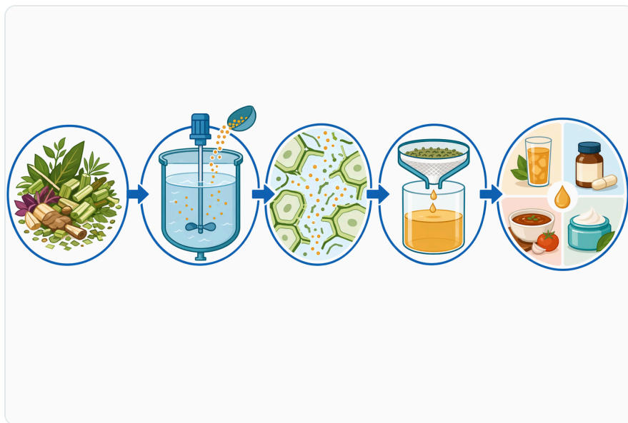
Figure 8. 일반적인 효소 보조 추출 과정에서는 정화 및 후속 마무리 공정 전에 수성 침지, 불림, 슬러리 유지 또는 추출 단계에서 \beta -글루카나아제를 첨가합니다.
