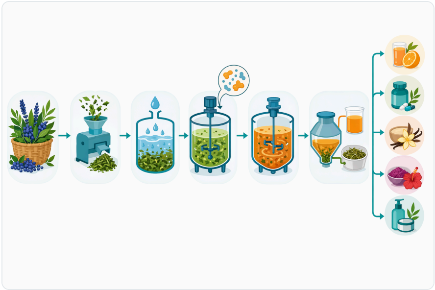
Figure 4. 在植物萃取中，纖維素酶通常會在水合或萃取階段加入，之後再進行固液分離及最終濃縮或乾燥。
