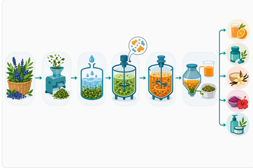
Figure 4. 식물 추출 공정에서 셀룰라아제는 일반적으로 고액 분리와 최종 농축 또는 건조 전에 수화 단계나 추출 단계에서 첨가됩니다
