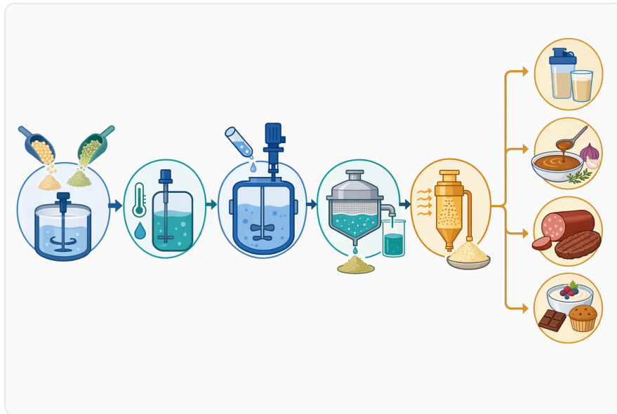
Figure 6. 典型的鹼性蛋白質水解製程包括基質水合、pH 調整、添加酵素、時間與溫度控制、終點選定、酵素失活，以及後續下游處理。
