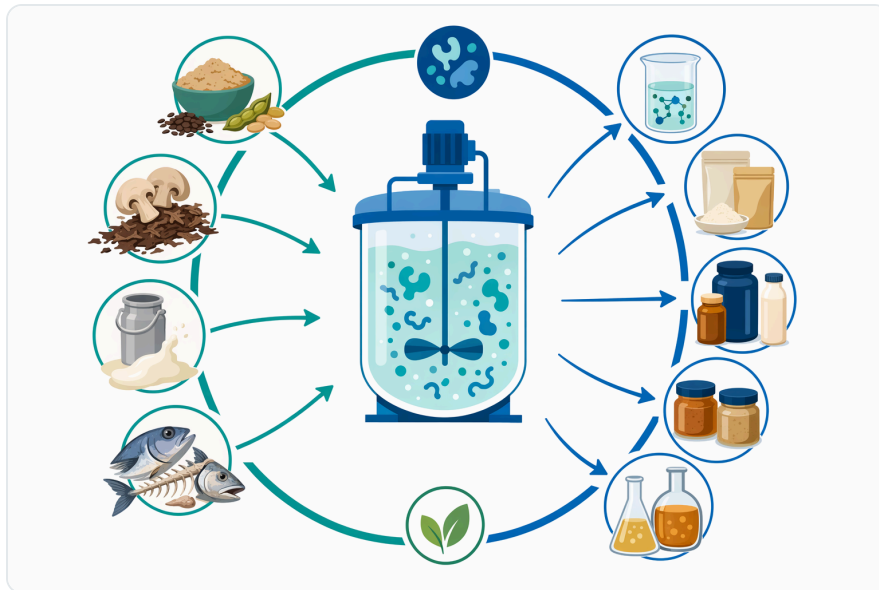
Figure 7. Thủy phân bằng enzyme có thể chuyển đổi các dòng phụ giàu protein thành các phần peptide hòa tan để sử dụng hơn cho các ứng dụng trong thực phẩm và nguyên liệu.
