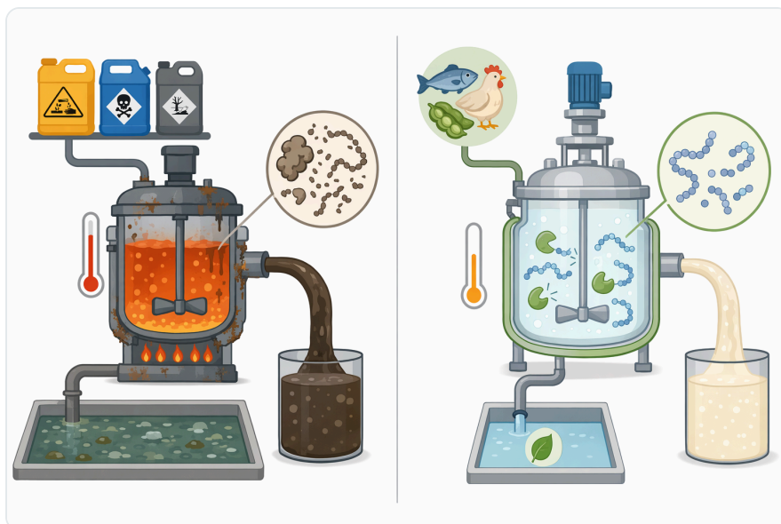
Figure 3. Protease axit, trung tính và kiềm được lựa chọn tùy theo pH của quy trình, đặc tính của cơ chất và sự cân bằng mong muốn giữa tốc độ thủy phân và chức năng của sản phẩm.
