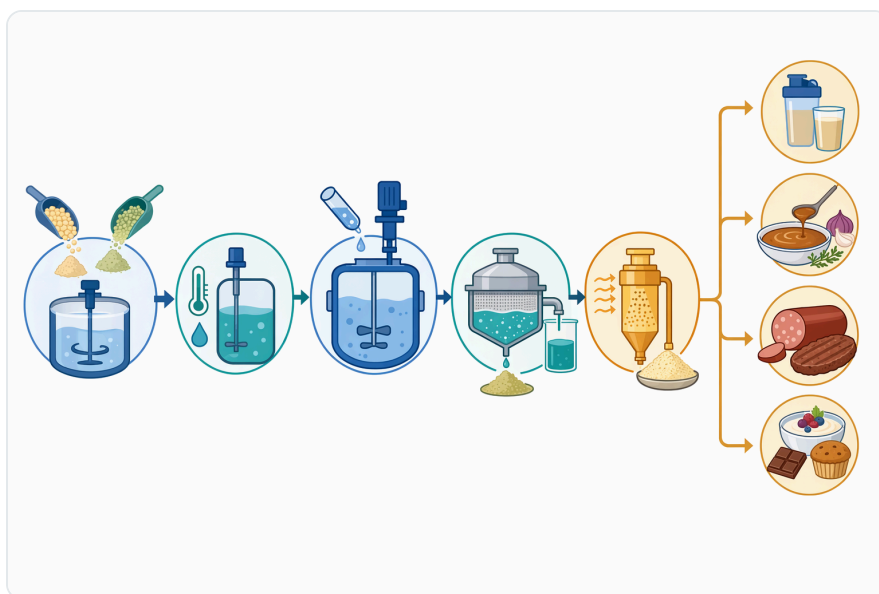
Figure 6. Một quy trình thủy phân protein kiềm điển hình bao gồm hydrat hóa cơ chất, điều chỉnh pH, bổ sung enzyme, kiểm soát thời gian và nhiệt độ, xác định điểm kết thúc, bất hoạt enzyme và xử lý ở các công đoạn sau.
