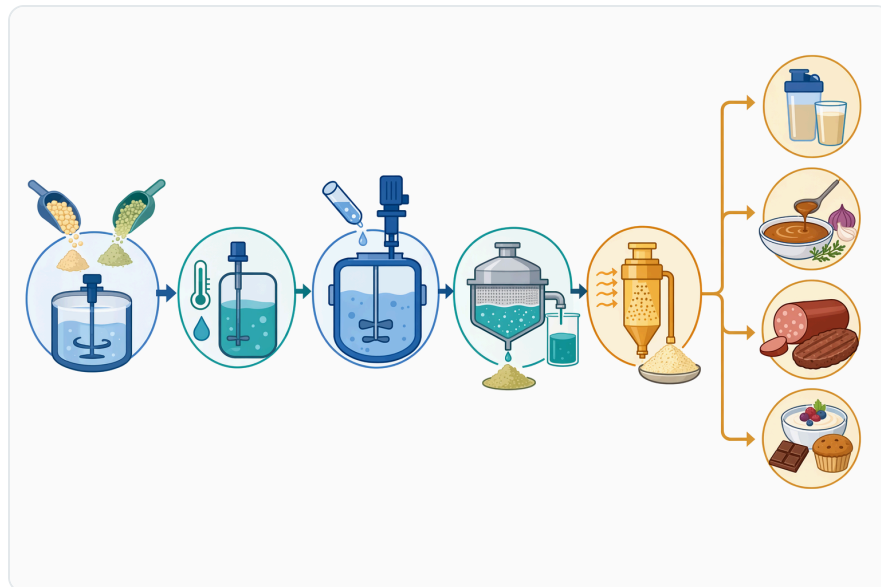
Figure 6. 일반적인 알칼리성 단백질 가수분해 공정에는 기질 수화, pH 조정, 효소 첨가, 시간-온도 제어, 중점 선정, 효소 불활성화, 후속 처리가 포함됩니다.
