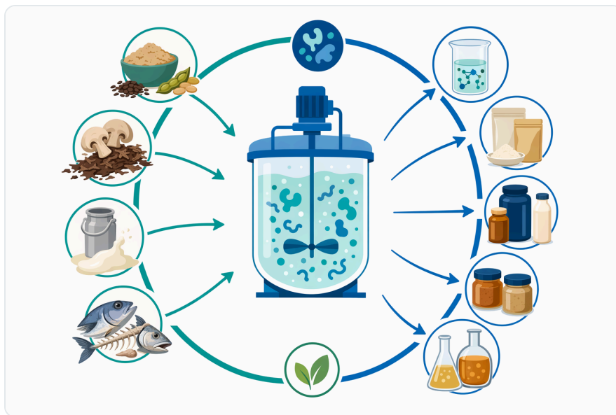
Figure 7. 효소 가수분해는 단백질이 풍부한 부산물을 식품 및 원료 응용에 더 활용하기 쉬운 수용성 펩타이드 분획으로 전환할 수 있습니다.
