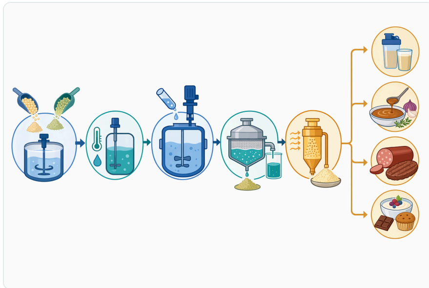
Figure 6. 일반적인 알칼리성 단백질 가수분해 공정에는 기질 수화, pH 조정, 효소 첨가, 시간-온도 제어, 종말점 설정, 효소 불활성화, 후속 처리가 포함됩니다.
