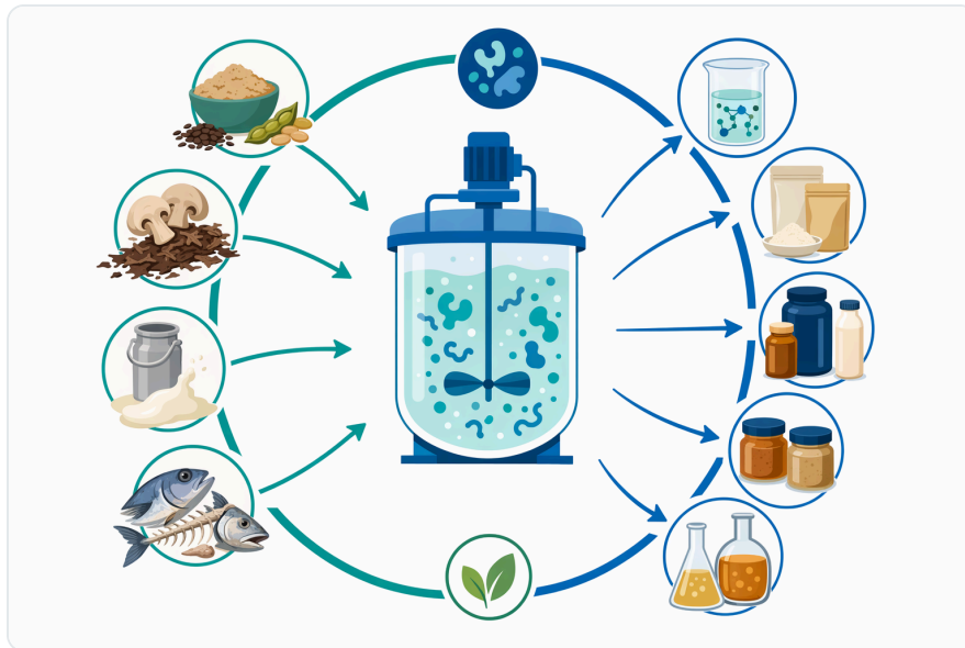
Figure 7. 효소 가수분해는 단백질이 풍부한 부산물 흐름을 식품 및 원료 용도에 더 활용하기 쉬운 수용성 펩타이드 분획으로 전환할 수 있습니다.
