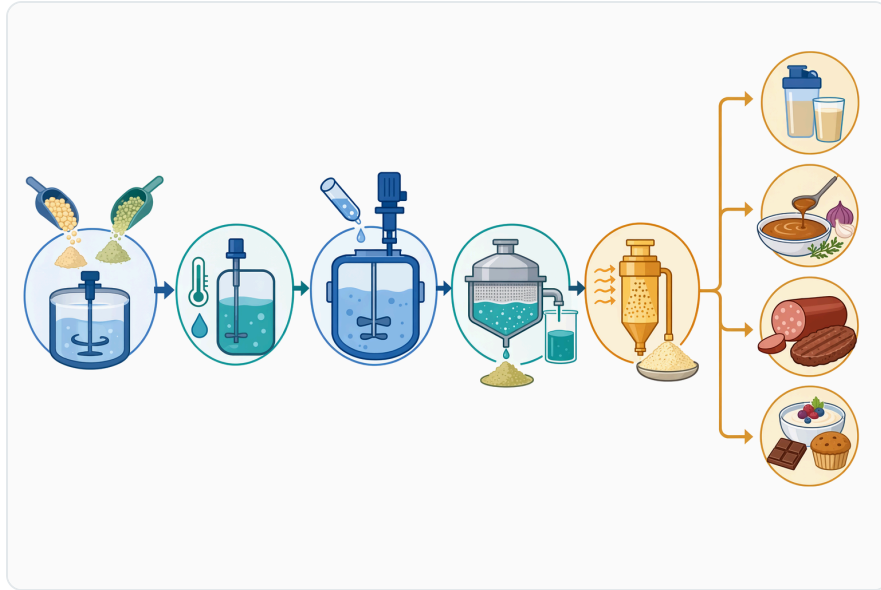
Figure 6. 일반적인 알칼리성 단백질 가수분해 공정에는 기질 수화, pH 조절, 효소 첨가, 시간-온도 제어, 반응 종점 선정, 효소 불활성화, 후속 처리가 포함됩니다.
