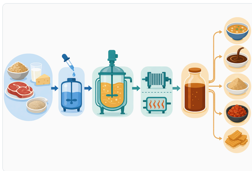
Figure 6. 실제 아미노펩티다아제 공정은 일반적으로 수화 및 기질 준비, 1차 단백질 분해 또는 발효, 펩타이드 말단 절단, 종말점 관리, 열 안정화 또는 후속 처리로 이루어진다.
