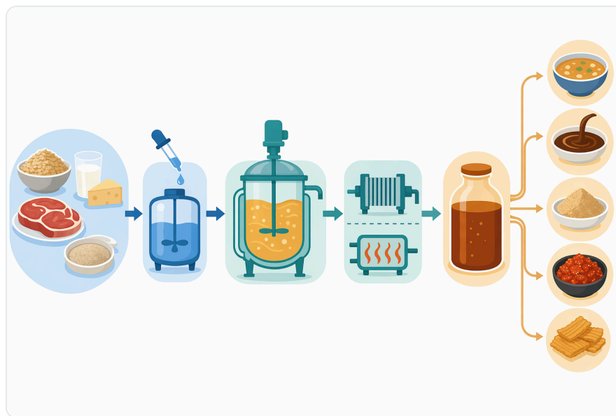
Figure 6. 실용적인 아미노펩티다아제 공정은 일반적으로 수화 및 기질 준비, 1차 단백질 분해 또는 발효, 펩타이드 말단 절단, 종점 제어, 열 안정화 또는 후속 처리를 포함합니다.
