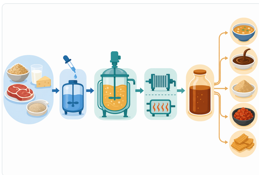
Figure 6. 실용적인 아미노펩티다아제 공정은 일반적으로 수화 및 기질 준비, 1차 단백질 분해 또는 발효, 펩타이드 말단 절단, 종점 제어, 열 안정화 또는 후속 공정으로 이루어진다.
