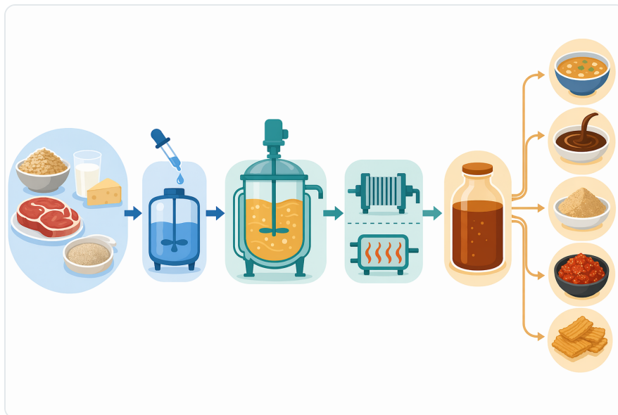
Figure 6. 실용적인 아미노펩티다아제 공정은 일반적으로 수화 및 기질 준비, 1차 단백질 분해 또는 발효, 펩타이드 말단 절단, 종말점 관리, 열 안정화 또는 후속 공정으로 이루어집니다.
