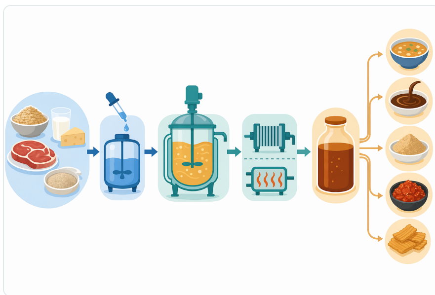
Figure 6. 실용적인 아미노펩티다아제 공정은 일반적으로 수화 및 기질 준비, 1차 단백질 분해 또는 발효, 펩타이드 말단 절단, 종말점 관리, 열 안정화 또는 후속 가공으로 이루어집니다.
