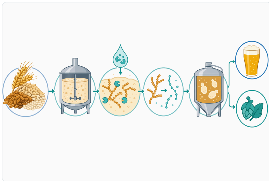
Figure 5. 가지제거 효소는 분지 덱스트린에 접근 가능한 시점과 목표로 하는 발효도 프로파일에 따라 당화 공정, 맥즙 처리 또는 특정 발효 설계에 적용될 수 있다.
