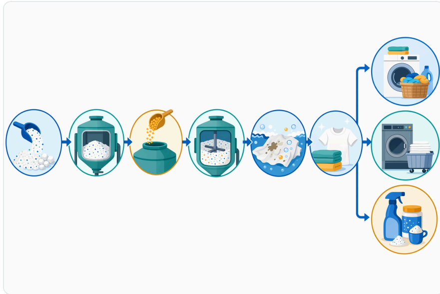
Figure 1. 冷漂酶顆粒是一種乾式配方添加劑，通常與界面活性劑、助洗劑、酶以及氧系漂白來源搭配使用，而不是作為成品洗衣劑。
