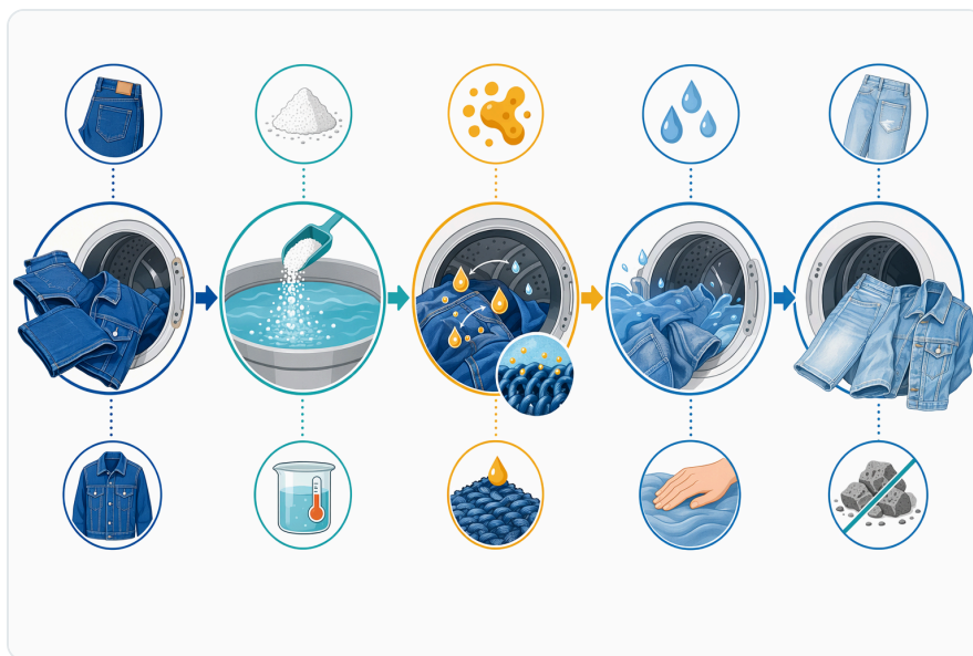
Figure 5. 纖維素酶石洗是一道濕式機械流程，其中酵素接觸、翻滾、鬆動物質去除、終止反應與漂洗都必須受到控制。
