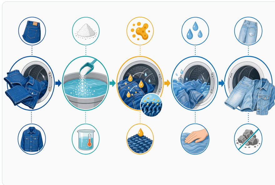
Figure 5. 셀룰라아제 스톤 워싱은 효소 접촉, 텀블링, 느슨해진 물질의 제거, 반응 정지, 행굼을 제어해야 하는 습식 기계 공정이다.
