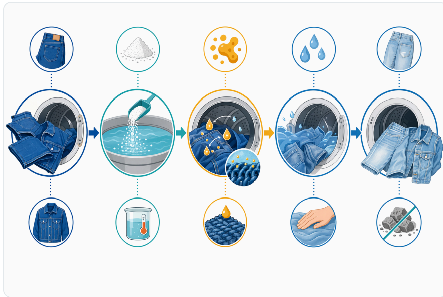
Figure 5. 셀룰라아제 스톤 위싱은 효소 접촉, 텀블링, 느슨해진 물질 제거, 반응 정지, 행굼을 제어해야 하는 습식 기계 공정이다.
