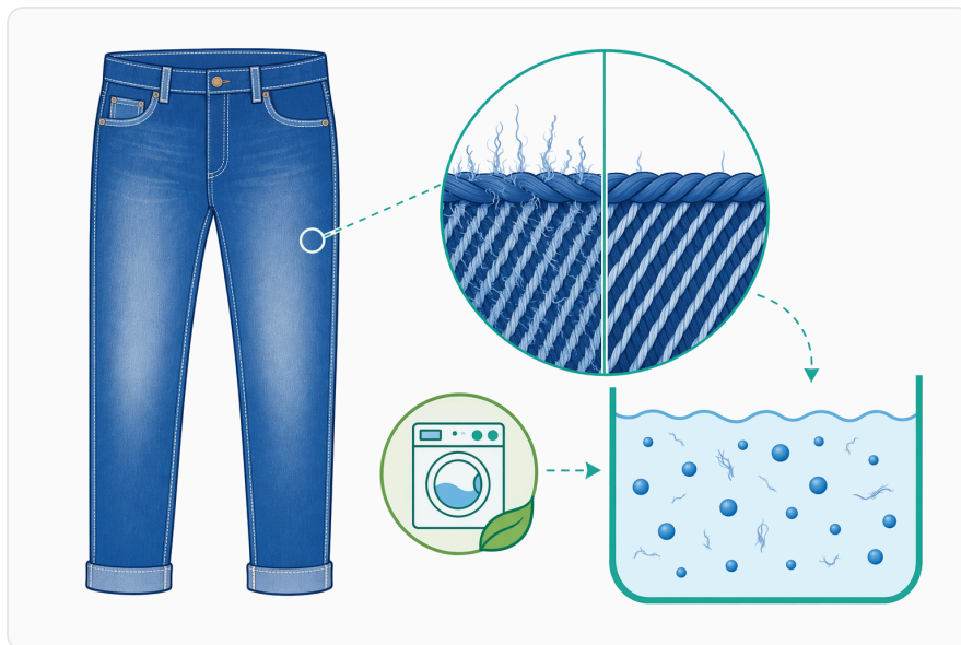
Figure 4. 효소 스톤 워싱은 노출 부위의 색조를 낮추고, 표면 보풀을 줄이며, 촉감을 부드럽게 하고, 염료가 포함된 미세 입자를 세척액으로 방출할 수 있다.
