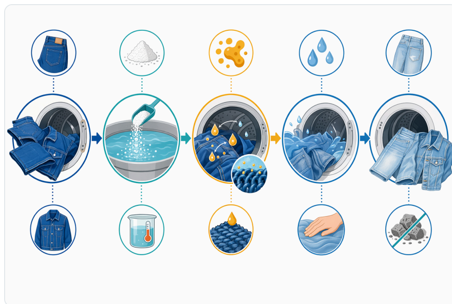
Figure 5. 셀룰라아제 스톤 워싱은 효소 접촉, 텀블링, 느슨해진 물질 제거, 반응 정지, 행굼을 제어해야 하는 습식 기계 공정이다.
