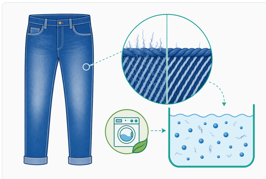
Figure 4. 효소 스톤 워싱은 노출 부위의 색상을 열게 하고, 표면 보풀을 줄이며, 촉감을 부드럽게 하고, 염료가 포함된 미세 입자를 세척액으로 방출할 수 있다.
