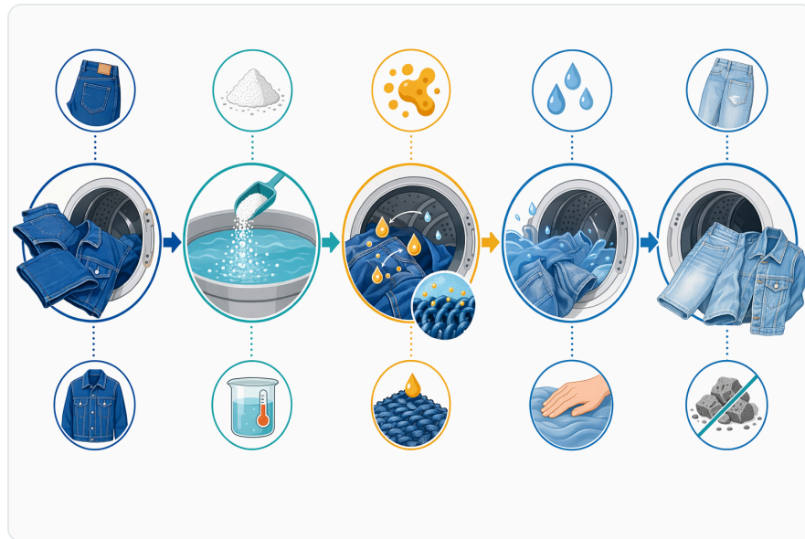
Figure 5. 셀룰라아제 스톤 워싱은 효소 접촉, 텀블링, 느슨해진 물질의 제거, 반응 정지, 헹굼을 제어해야 하는 습식 기계 공정이다.
