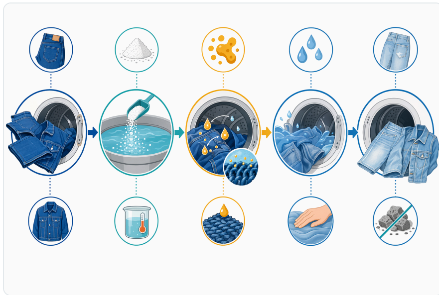
Figure 5. 셀룰라아제 스톤 워싱은 효소 접촉, 텀블링, 느슨해진 물질 제거, 반응 정지, 행굼을 제어해야 하는 습식 기계 공정입니다
